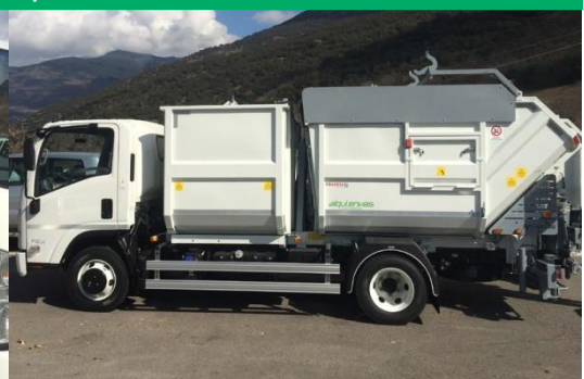
Vehículo Bicompartimentado con Compactadora a la Cuba Posterior y Elevación a la Cuba Anterior
