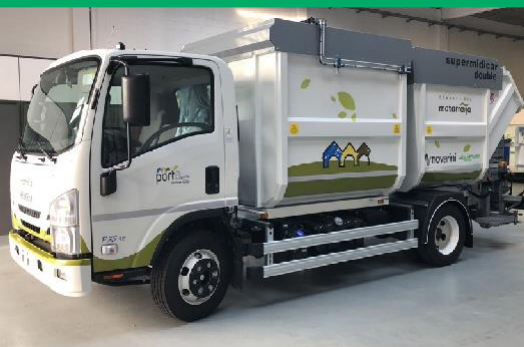
Vehículo Bicompartimentado con Compactadora a las dos Cubas
