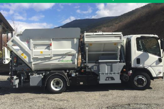
Vehículo Bicompartimentado con Compactadora a la Cuba Posterior y Elevación a la Cuba Anterior
