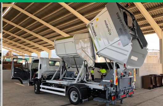
Vehículo Bicompartimentado con Compactadora a las dos Cubas
