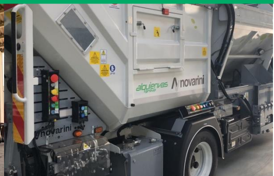
Vehículo Bicompartimentado con Compactadora a la Cuba Posterior y Elevación a la Cuba Anterior
