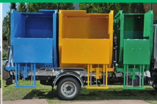
Vehículo Triple Tank con tres Tanques Basculantes
