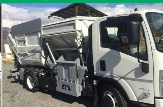
Vehículo Bicompartimentado con Compactadora a la Cuba Posterior y Elevación a la Cuba Anterior
