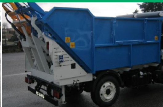
Vehicle Bicompartimentado Sin Compactador con dos Cubas Posteriores
