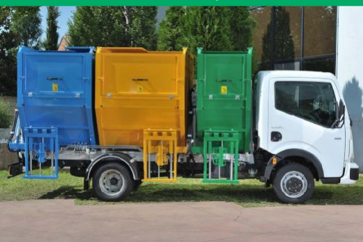
Vehículo Triple Tank con tres Tanques Basculantes
